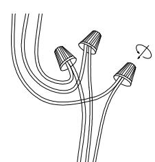
Haz la conexión eléctrica a prueba de agua.
