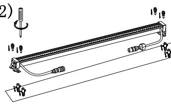
Asegura la base sobre la superficie de instalación con ayuda de los taquetes y tornillos.
