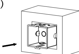
Haz un recorte de 117\*17mm sobre la superficie de instalación e inserta la caja de la luminaria.
