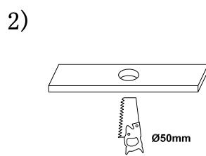
Haz un recorte de Ø50mm sobre la superficie de instalación.
