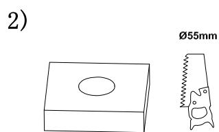
Haz un recorte en la superficie de Ø55mm y al menos 75mm de profundidad.
