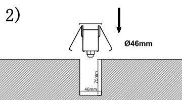
Haz un recorte en la superficie de Ø46mm y al menos 75mm de profundidad.
