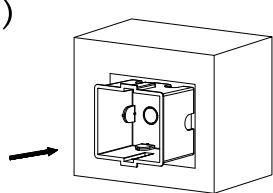
Haz un recorte de 117\*17mm sobre la superficie de instalación e inserta la caja de la luminaria.
