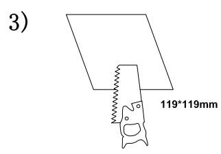
Haz un recorte de 119\*119mm en la superficie de Instalación.
