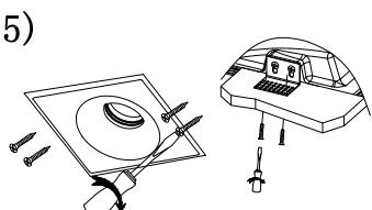
Atornilla la aleta de fijación a la tablero con ayuda de un desarmador.
