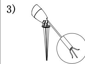
Haz la conexión eléctrica con un empalme a prueba de agua.
