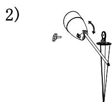
Ajusta el ángulo de la luminaria usando la articulación dentada.
