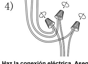
4) Haz la conexión eléctrica. Asegúrate de aplicar un empalme a prueba de agua.
