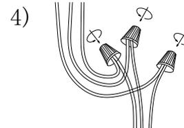
4) Haz la conexión eléctrica. Asegúrate de aplicar un empalme a prueba de agua.
