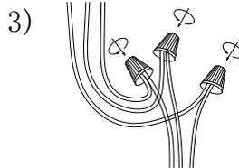
Haz la conexión eléctrica. Asegúrate de aplicar un empalme a prueba de agua.
