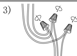
Haz la conexión eléctrica. Asegúrate de aplicar un empalme a prueba de agua.
