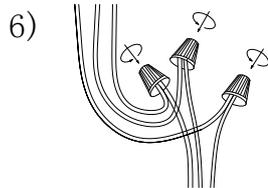
6) **Haz la conexión eléctrica. Asegúrate de aplicar un emplame a prueba de agua.**
