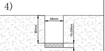
4) **Cava un hoyo de las dimensiones y asegúrate de dejar 10-20cm de tierra para filtración de agua.**
