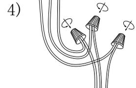
4) Haz la conexión eléctrica. Asegúrate de aplicar un empalme a prueba de agua.
