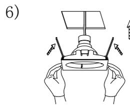
6) Levanta los aleros laterales e introduce la luminaria en la losa.
