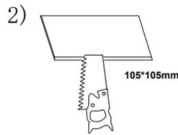
2) Haz un recorte de 105\*105mm en la superficie de instalación.
