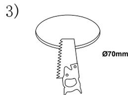
3) Haz un recorte de  $\varnothing 70\text{mm}$  en la superficie de instalación.
