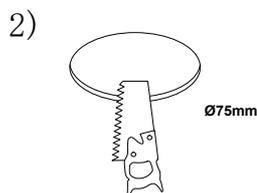
2) Haz un recorte de Ø75mm en la superficie de instalación.
