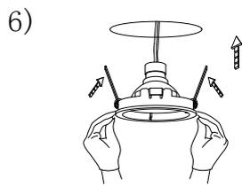
6) Levanta los aleros laterales e introduce la luminaria en la losa.
