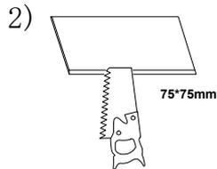
2) Haz un recorte de 75\*75mm en la superficie de instalación.
