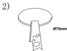
Haz un recorte de Ø75mm en la superficie de instalación.
