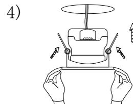
Levanta los aleros laterales e introduce la luminaria en la losa.
