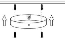
Fija el marco a la superficie usando taquetes y tornillos.
