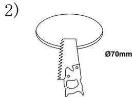
2) Haz un recorte de Ø70mm en la superficie de instalación.
