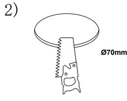
2) Haz un recorte de  $\varnothing 70\text{mm}$  en la superficie de instalación.
