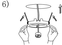
6) Levanta los aleros laterales para instalar la luminaria dentro de la losa.
