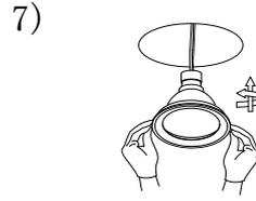
7) Vuelve a colocar el aro con el GU10 instalado de vuelta a la luminaria.
