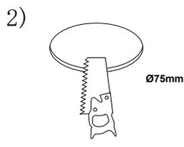
2) Haz un recorte de Ø75mm en la superficie de instalación.
