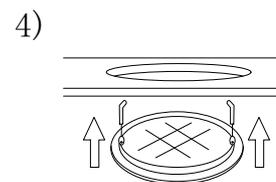
Levanta los aleros laterales e instala la luminaria dentro de la losa.
