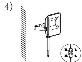
Haz la conexión eléctrica para terminar con la instalación.
