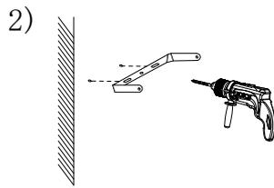
Instala la contra de la luminaria sobre la superficie de instalación.
