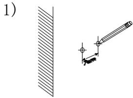
Marca 2 puntos sobre la superficie con una separación de 7cm.
