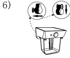
Monta la luminaria sobre el espacio entre el muro y los tornillos.
