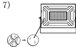
7) No encienda la luminaria si la cubierta está rota o dañada, entre en contacto con su proveedor.
