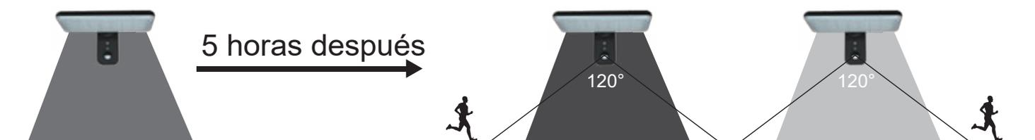
La luminaria automáticamente enciende por la noche al 60% de su potencia y se mantiene así por las primeras 5 horas, después pasa a "Modo Sensor de Movimiento"
